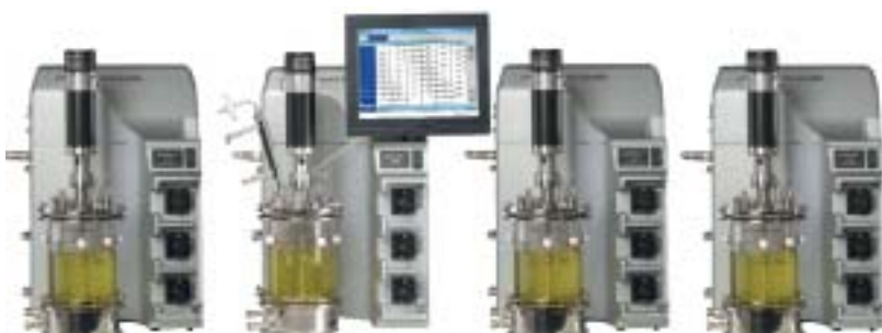
Bis zu vier Fermentoren liegen zusammen an einer Steuerung.
